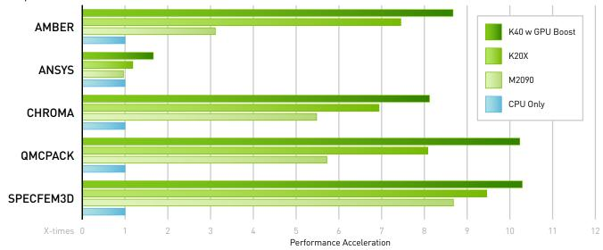
Dual E5-2687W, 16 Cores, 3.1GHz. 64GB DDR3, ECC On. CentOS 6.2 x86\_64.
